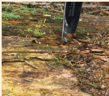
Fortgeschrittene Zersetzung, das Messer dringt in Faserrichtung leicht ein, quer zur Faser aber nicht (Morschholz)
