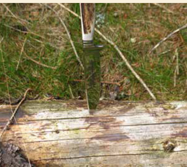
Beginnende Zersetzung, das Messer dringt in Faserrichtung nur schwer ein (Totholz)
