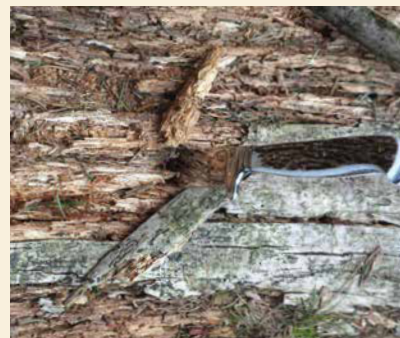
Stark zersetzt, das Messer dringt in jede Richtung leicht ins Totholz ein (Moderholz)
